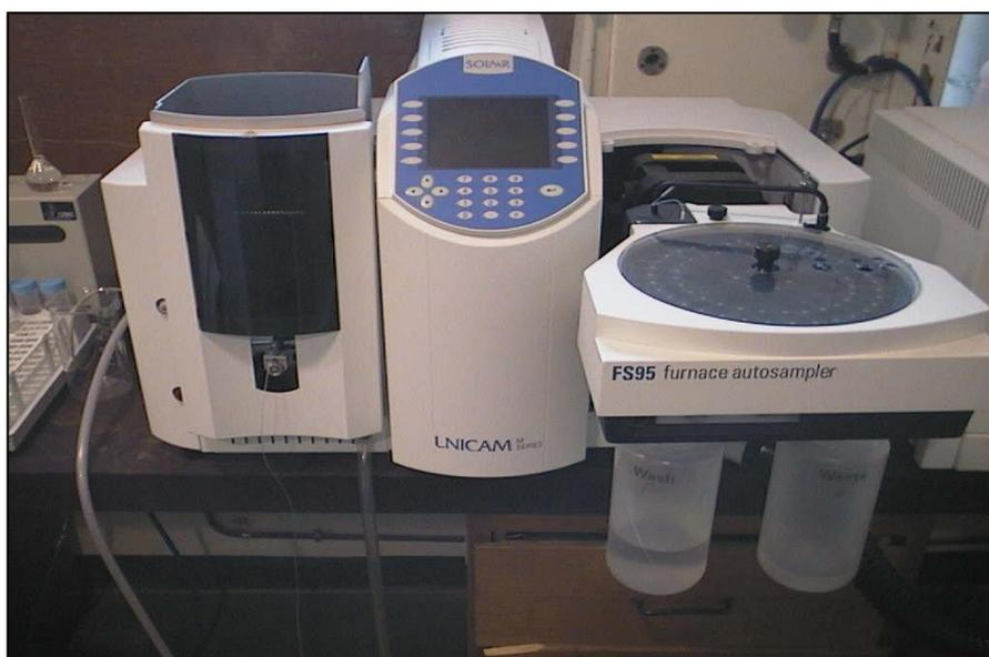
**Fig.19.** La spectrophotométrie d'absorption atomique SAA
