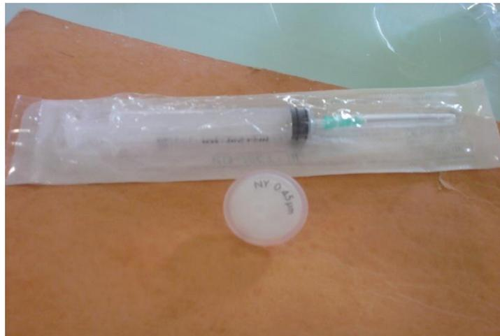
**Fig.17.** le dispositif de la filtration à  $0.45\mu\text{m}$
